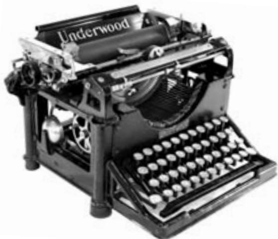
Machine classique, simple. Écriture visible. Première machine commerciale visible. Les principes fondamentaux de cette machine ne furent pas modifiés et la progression des différents modèles, jusqu'au no 12 ne furent pas très spectaculaires. C'est une très bonne machine qui a très bien résisté au temps et à l'usage et qui, comme beaucoup d'autres marques a disparu du commerce avec l'arrivée des machines électroniques. Levier d'interligne à gauche.
