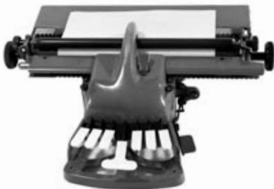
Le papier est fixé au cylindre par une plaque métallique à pointes, puis enroulé autour du cylindre, jusqu'au début de la feuille. Le papier est avancé au moyen d'un bouton du cylindre. Le retour du chariot se commande par un levier à droite du clavier et la libération par une touche sur le bloc central.
