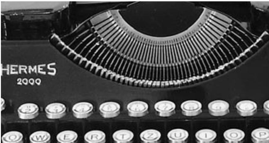
Clavier de trois rangées de touches, soit 3 signes par touche. Les caractères sont sur une plaquette interchangeable qui se place sur un support mobile. En tapant sur une touche, la plaquette tourne et le caractère choisi se positionne devant le point d'impression. Un marteau pousse le papier contre le caractère. Le mécanisme de frappe est actionné par un ressort, ce qui donne une impression très régulière.
