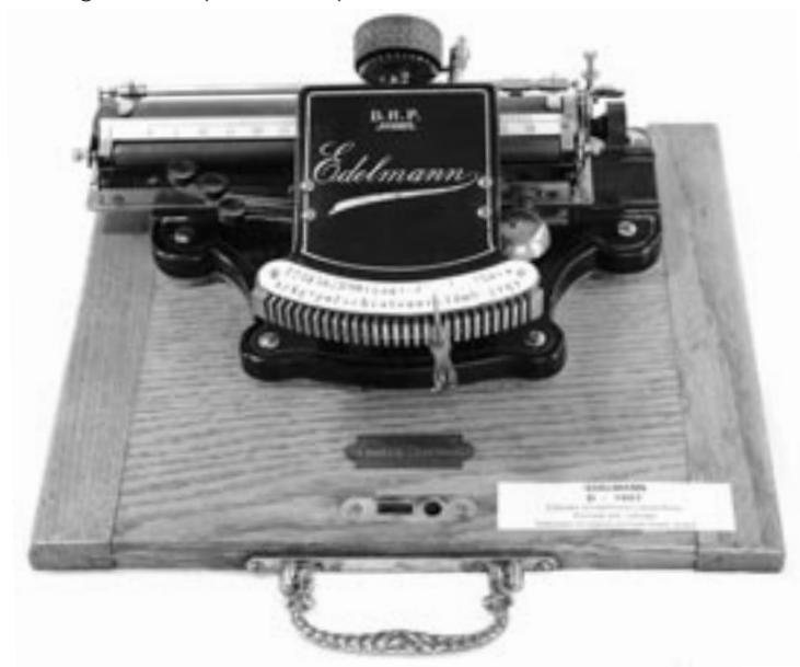
Machine à cylindre d'impression en caoutchouc. Encrage par un petit tampon encreur mobile, placé entre les caractères et le cylindre. En appuyant sur la touche, tout le cylindre des caractères descend en positionnant le caractère choisi, qui s'encre en passant sur le tampon encreur puis s'imprime sur le papier. L'encreur doit être souvent re-encreé. Sonnette de fin de ligne à la place du bouton de droite du cylindre.
