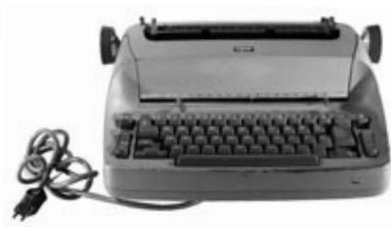
Machine à sphère d'impression (boule). Ce système à boule a complètement modifié la conception des machines de cette époque, en apportant beaucoup de possibilités d'utilisation. Cette machine est équipée d'un ruban tissus, mais dans une cassette. Par la suite le tissus fut remplacé par du carbone ce qui permettait un
