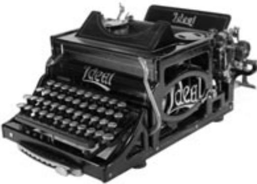
Machine très avancée pour son époque. Elle est équipée du «retour du chariot et interligne», par un levier de rappel, à droite au dessus du clavier. D'un tabulateur décimal de 10 colonnes, commandé par un poussoir en avant du clavier. Les barres à caractères sont dirigées séparément par un guide, au départ du segment, ce qui donne une écriture régulière. Le bâti est ajouré et décoratif. Ruban 11 mm.
