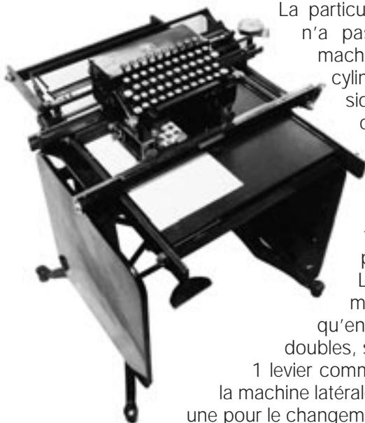
La particularité de cette machine est qu'elle n'a pas de chariot, comme toutes les machines. Le papier n'est pas fixé sur un cylindre. Tout le mécanisme d'impression se déplace latéralement et verticalement sur un support mobile. Le tout est monté sur une table. Le papier est fixé sur une table par les côtés et les caractères tapent du haut en bas. Une pédale sous la table commande la libération du papier.
